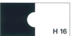
Fingerhohlschnitt ø 16 mm - Typ H 16 Standard-Schnittform Variable Schnitttiefe bis max. 8 mm Variable Schnitthöhe bis max. 16 mm
