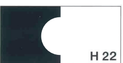
Fingerhohlschnitt ø 22 mm - Typ H 22 Standard-Schnittform Variable Schnitttiefe bis max. 11 mm Variable Schnitthöhe bis max. 22 mm
